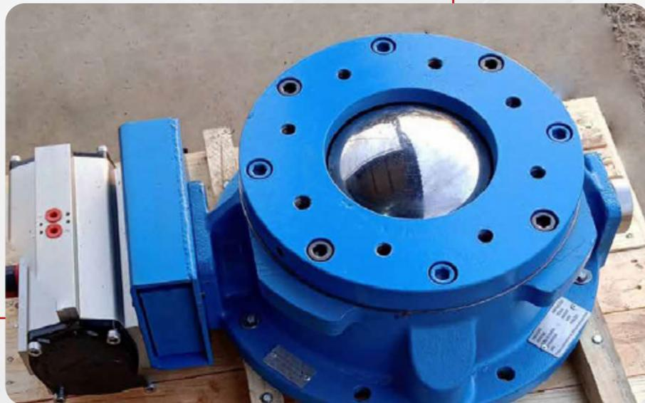
Depois do revestimento aplicado pelo método de aspersão térmica, a válvula domo foi colocada em trabalho de campo e o estudo de caso está sendo acompanhado em tempo real.
