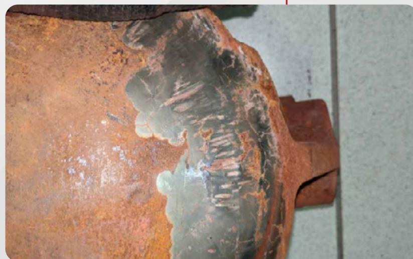
Antes destes estudos em revestimentos, as Válvulas Domo Uniprest necessitavam de paradas para manutenção a cada três meses, gerando custos de substituição e recuperação, além da perda de produtividade no período.
